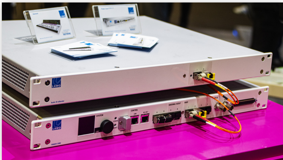
Блок расширения AIOX (сверху), подключенный к процессору Power Core
