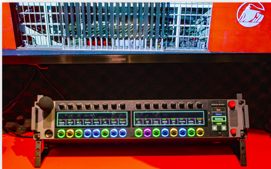
Многоканальный мониторинг аудиопотоков с помощью приложения Riedel AMA
