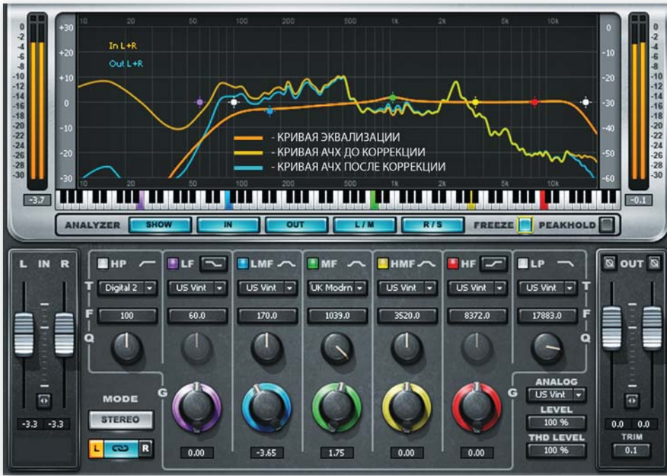
Параметрический эквалайзер с функцией спектрального анализатора
