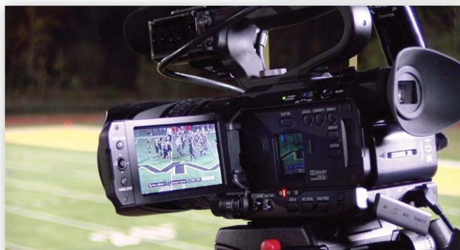
GY-HM200SP – на дисплее видна наложенная камерой графика
