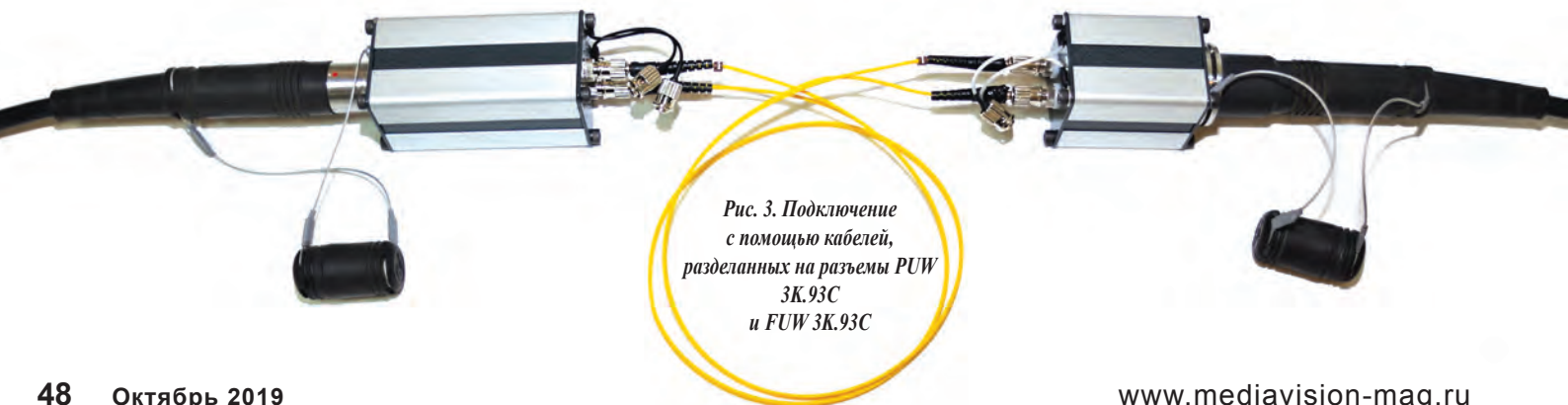
Рис. 1. Комплект HFOF для организации камерного канала без применения гибридного кабеля
