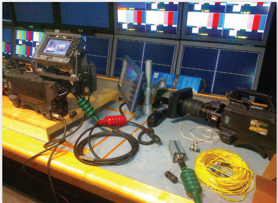
Рис. 6. Первые испытания комплекта HFOF с камерой Sony HDC-1500
