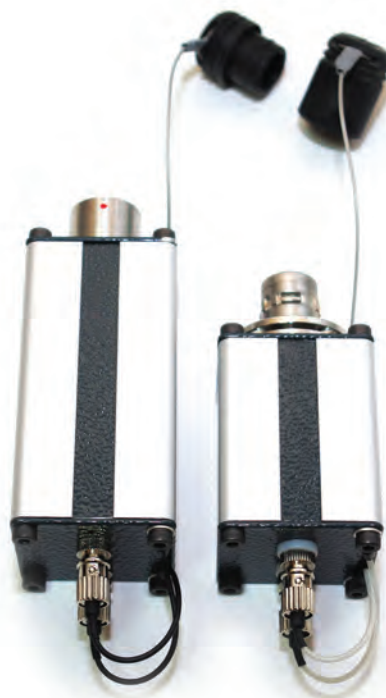
Рис. 2. Устройства комплекта HFOF с разъемами ST UPC
