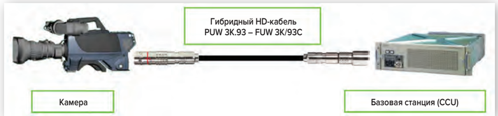
Рис. 4. Подключение камеры к базовой станции гибридным кабелем
