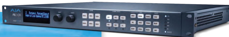
Кадровый синхронизатор и конвертер форматов AJA FS-HDR
