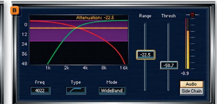
Рис. 6. Выбор диапазона, в котором выполняется уменьшение громкости: узкий диапазон на выбранной частоте (а); весь высокочастотный диапазон, лежащий выше опорной частоты (б); полный частотный диапазон (в)
