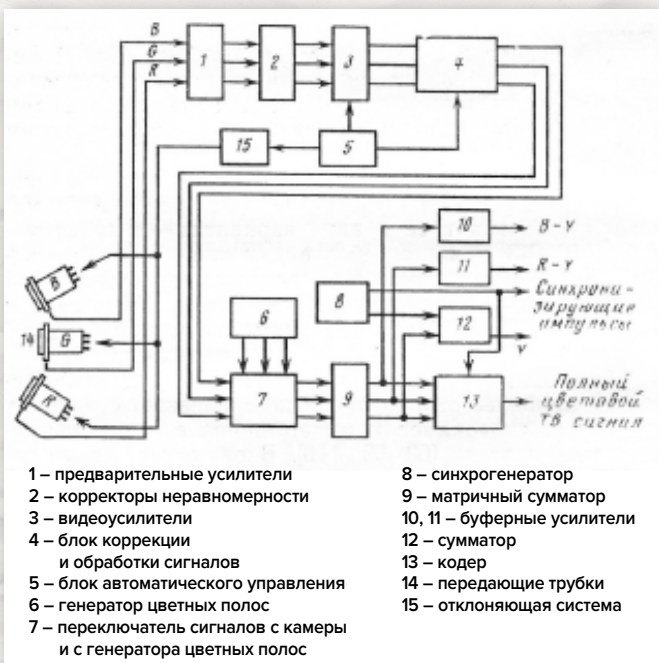
Структурная схема трехтрубчатой камеры Sony VBP-3
