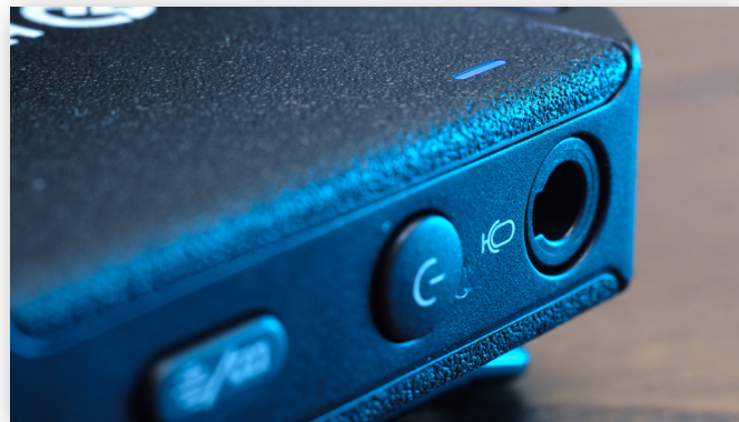
Кнопка включения/выключения и вход для внешнего микрофона
