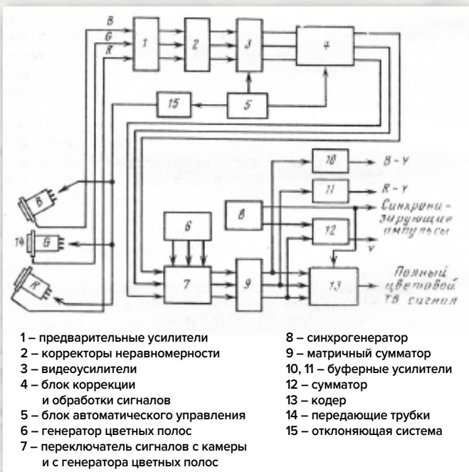
Структурная схема трехтрубной камеры Sony VBP-3
