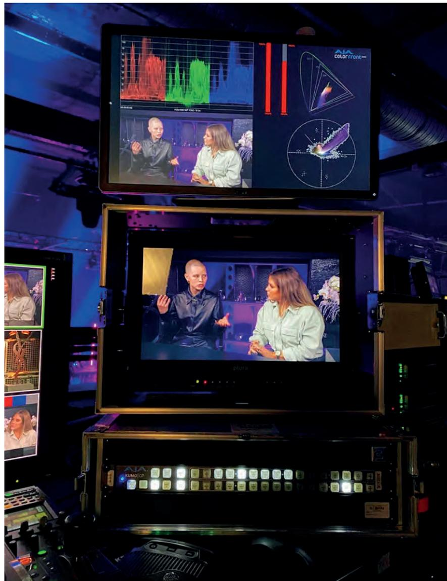
*Применение AJA HDR Image Analyzer в процессе трансляции*
