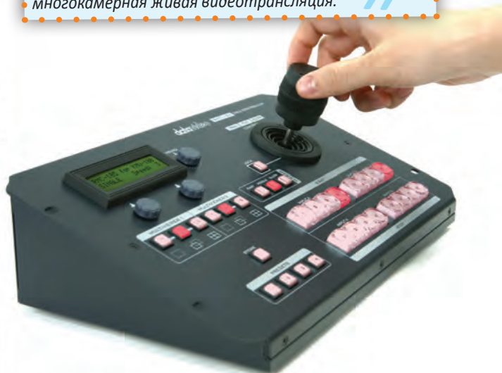
Рис. 2. Слева – исходное 4K-изображение (внизу) и планы четырех виртуальных камер. Справа – контроллер RMC-185
