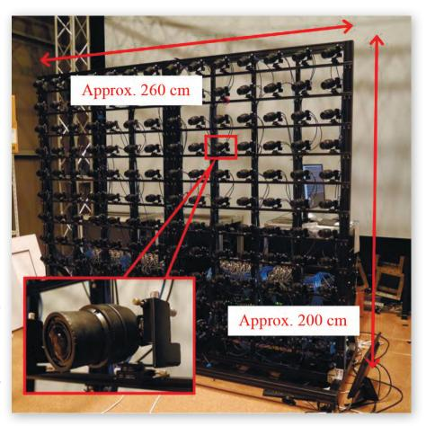
Роботизированная многокамерная система для 3D-съемки
