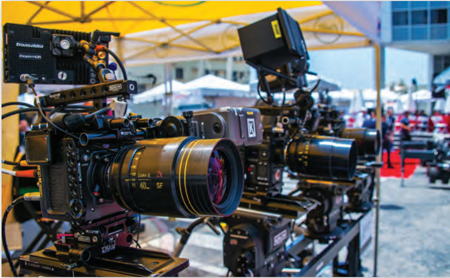
40-мм анаморфотный объектив Cooke Anamorphic/i Full Frame Plus
