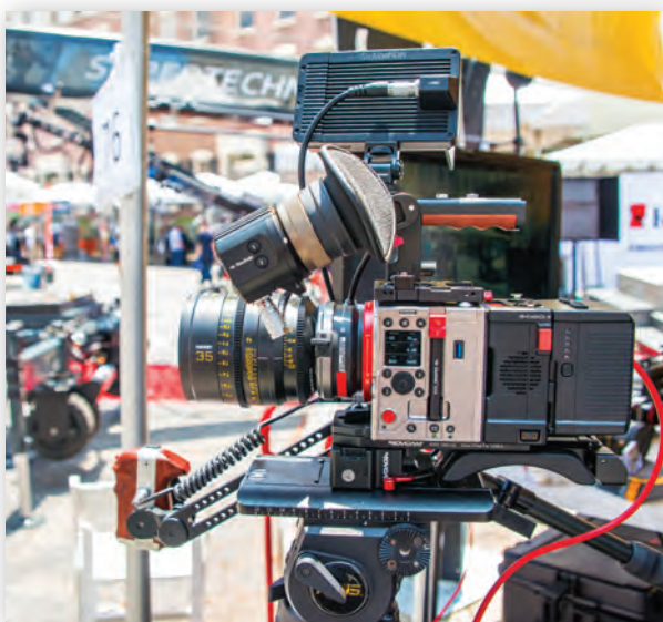
Камера Kinefinity MAVO LF с фирменными объективом, видоискателем, магазином KineMAG и интерфейсным модулем KineBACK-W
