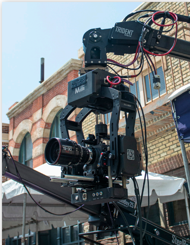
Активная гиростабилизированная головка OperTec Milli
