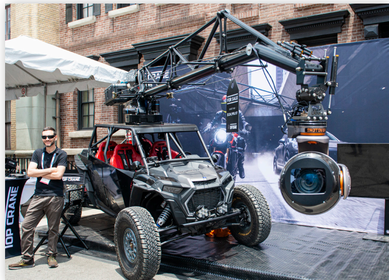
Кран с гиросtabilизированной моторизованной головкой, установленный на багги
