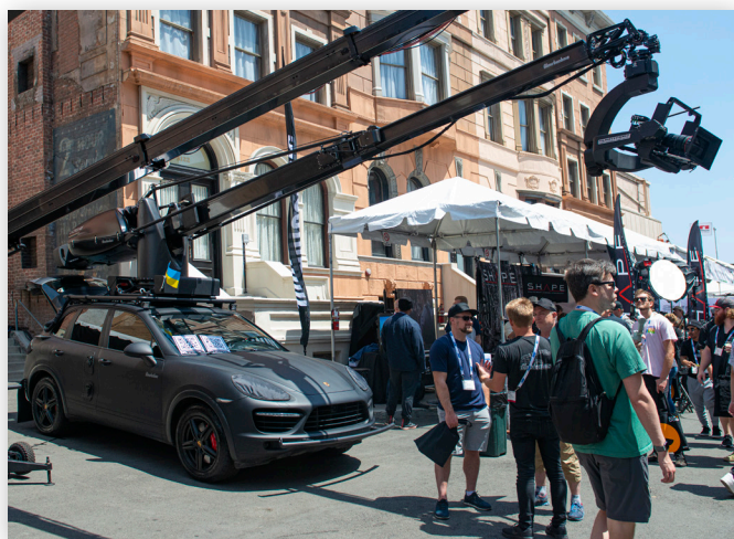
Установленный на джипе операторский кран Filmotechnic
