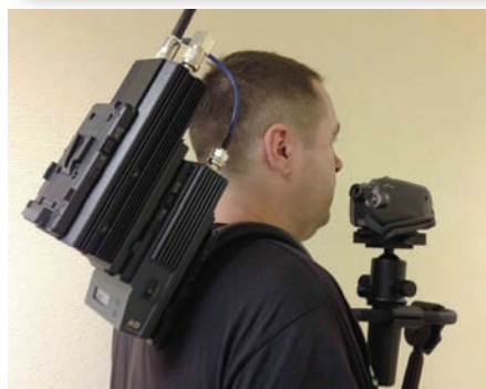
Передатчик VideoLink 700 HD/LD, закрепленный на камере и на плечевом упоре
