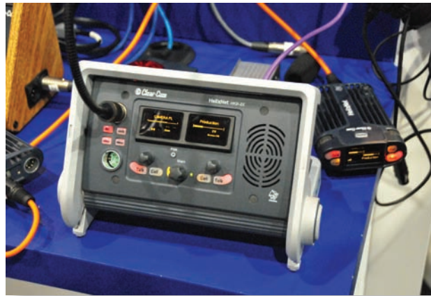
Станция НКВ-2X, закрепленная с помощью S-Mount
