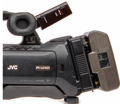
Модем, подключенный к камере и позволяющий выполнять потоковую передачу видео через сети сотовой связи
