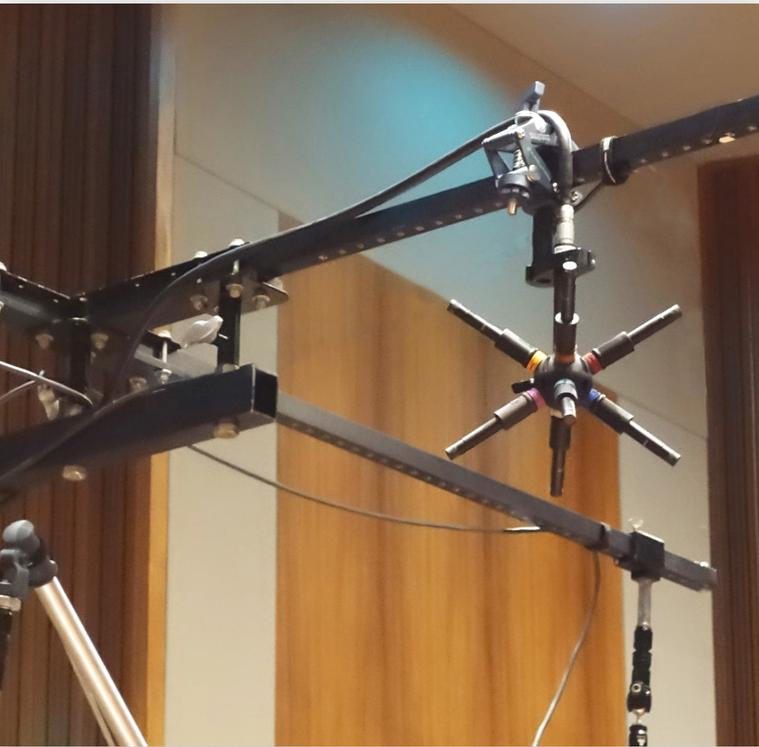
Микрофон объемного звука Audio-Technica VR3600, установленный в студии, где записывалась струнная секция оркестра для альбома Iron & Wine
