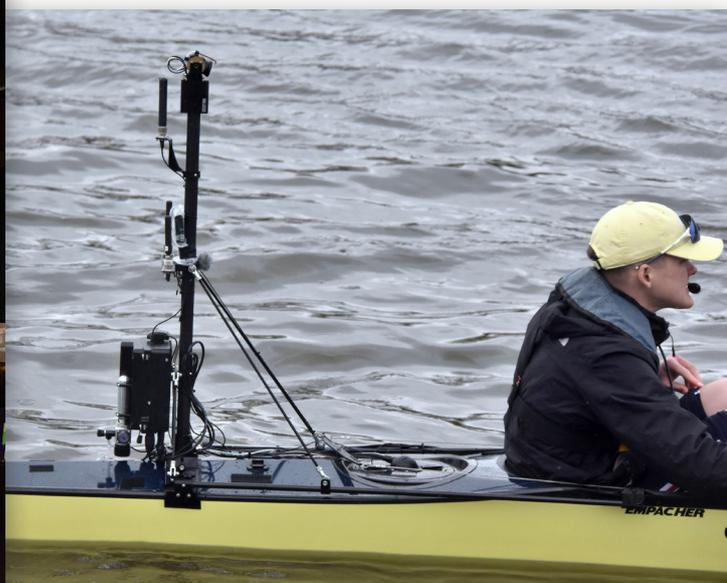
Съемочная система, установленная позади рулевого (фото Стива Чарльза)
