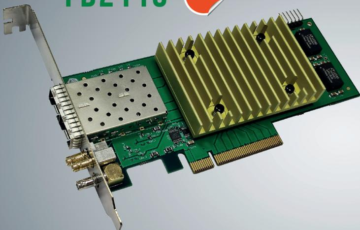
Низкопрофильная PCI-Express 3.0 x8 плата ввода/вывода для работы с SMPTE 2110/2022 2x 25G Ethernet и 2x 12G/3G/HD/SD-SDI/ASI сигналами.
