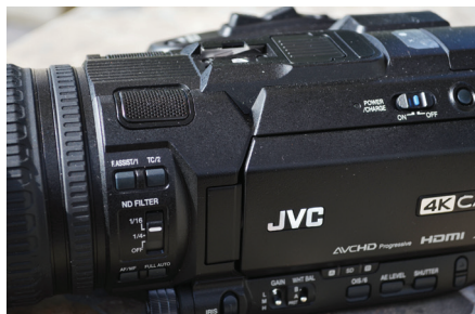
Камера без рукоятки – на верхней грани хорошо видны микрофоны
