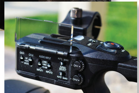
Органы управления записью звука на рукоятке камеры
