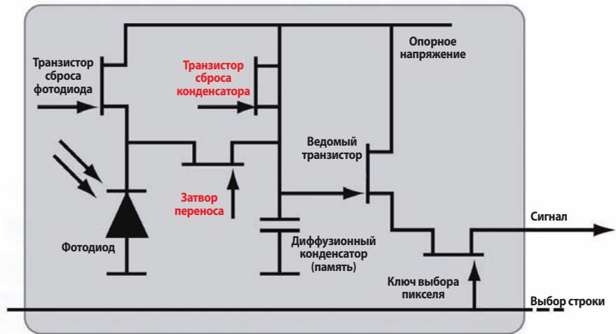
Пиксель типа 5Т в сенсоре Xensium-FT
