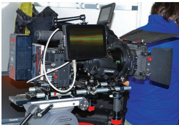
Съемочный комплект на основе Red Epic, вариобъектива Fujinon и штатива OConnor
