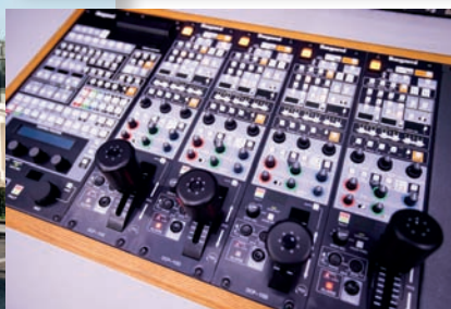
Рабочее место инженера, оснащенное пультами управления OCP-100
