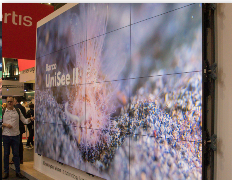
Видеостена, составленная из ЖК-дисплеев
