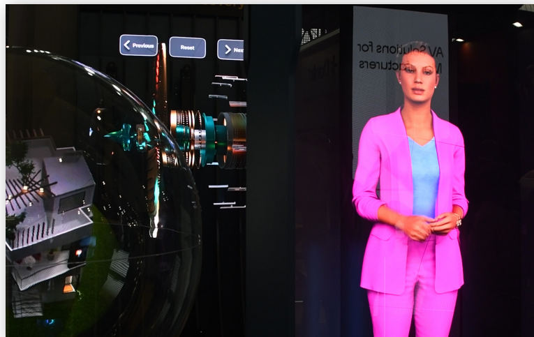
Изображение, созданное вращающимися массивами светодиодов
