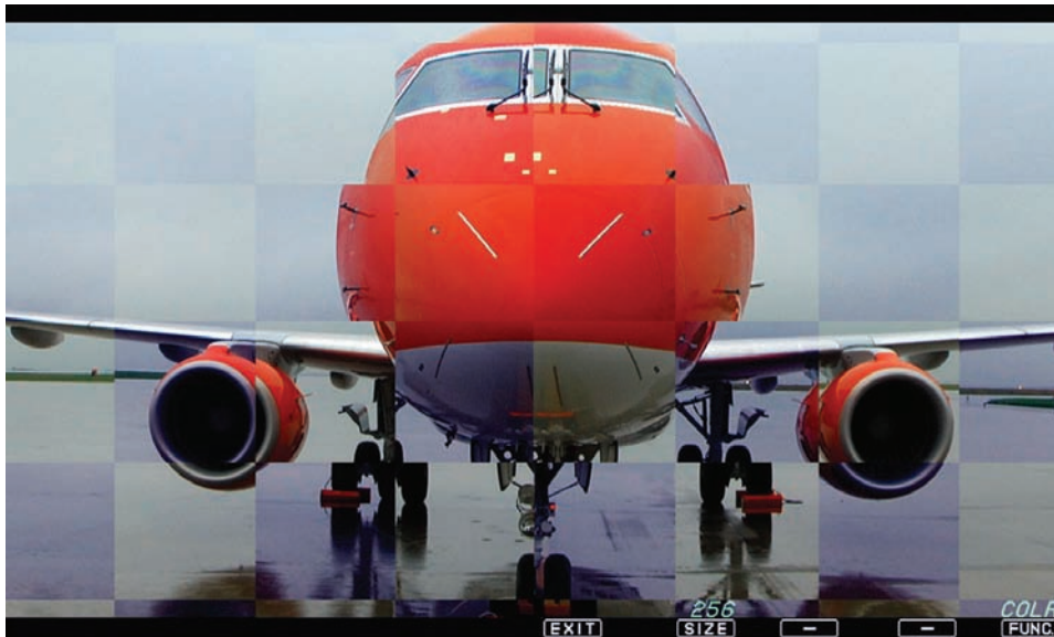
Проверка соответствия яркости и цветопередачи между правым и левым изображениям с помощью функции COLOR
