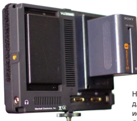
Монитор V-LCD56MD, на месте сменного модуля – заглушка
