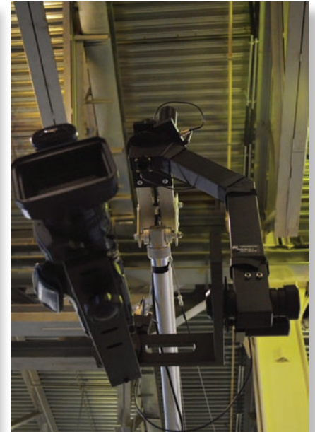
Дистанционно управляемая роботизированная панорамная головка, установленная на стреле крана
