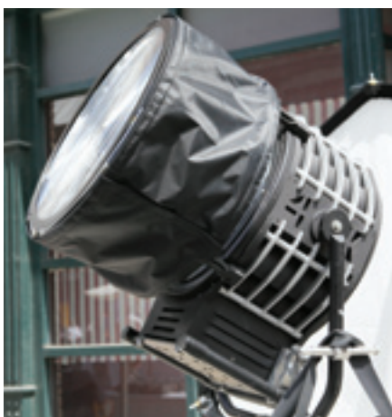
Прожектор K 5600 со двоянными линзами Френеля
