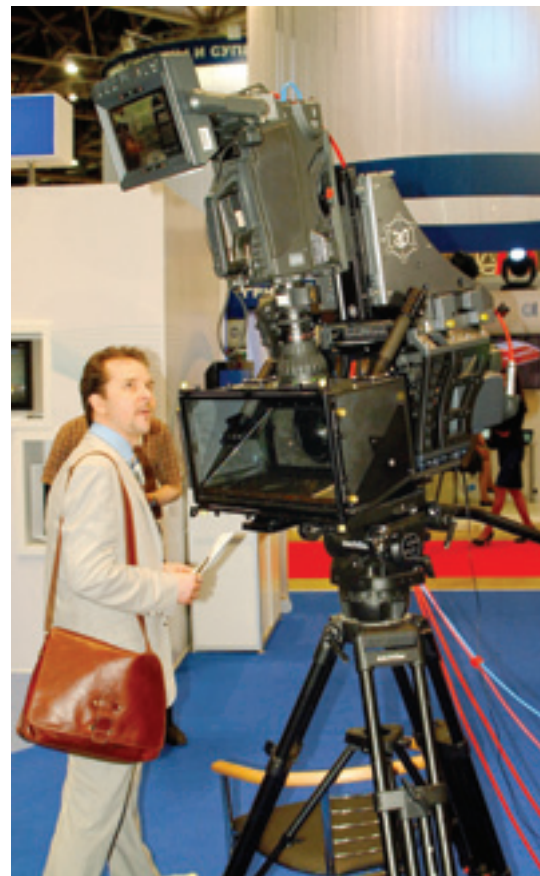
Комплект для 3D-съёмки на базе платформы Element Technica Quasar и камер Sony HDC-1550
