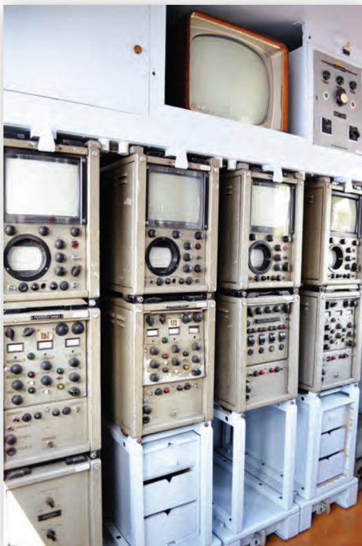
Система мониторинга в ПТС конца 1950 – начала 1960-х годов
