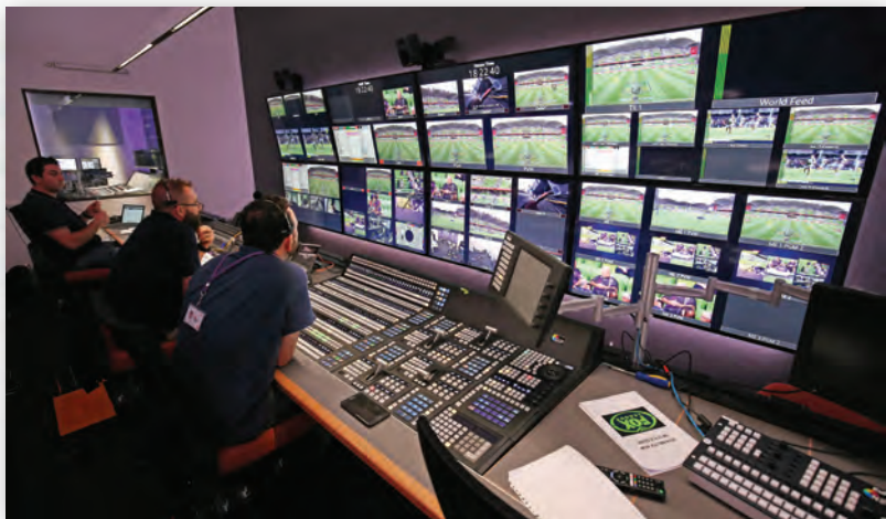
Система полиэкранного мониторинга Lawo в ПТС NEP
