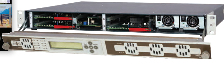
Корпус PROFNEXT 1RU для 24-входовой полиэкрannой системы
