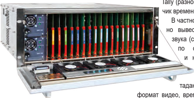
Шасси Axon Synapse, в которую устанавливаются модули SynView
