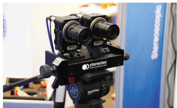
Съемочная 3D-система на основе миниатюрных камер и дискретных объективов
