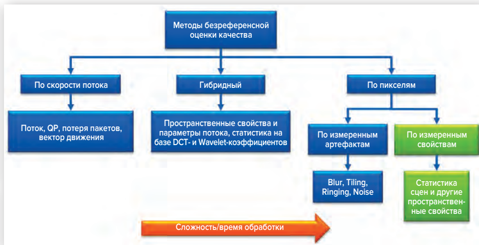
Рис. 7. Сложность и время обработки в привязке к иерархии безреференсных методов оценки качества видео
