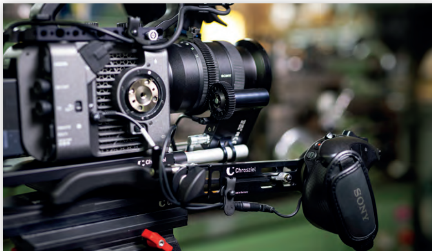
Zoomer на камере Sony ILME-FX6 с применением эластичного зубчатого кольца Flexi
