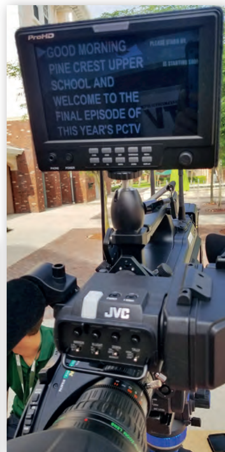
Использование накамерного монитора JVC в качестве телесуфлера
