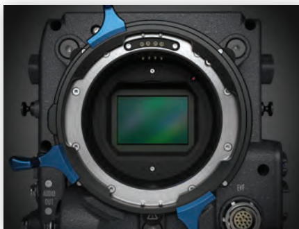
Камера ALEXA LF – вид на матрицу и крепление LPL
