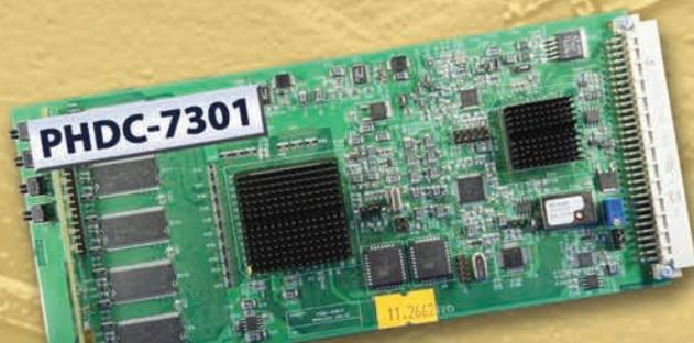
Преобразователь стандартов HD/SD-SDI. Повышающее, понижающее и перекрестное преобразование сигналов 3G/HD/SD, синхронизация выходного сигнала по опорному сигналу, поддержка передачи 16 каналов (4 группы) вложенного звука для всех стандартов, согласование задержки изображения и звука.
