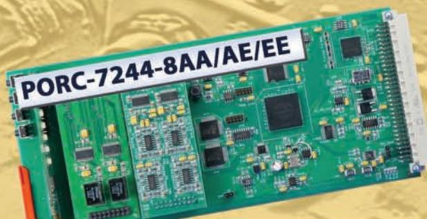
Оптические приемники с преобразованием HD/SD-SDI в SECAM/PAL/NTSC, SD-SDI и синхронизации, оснащенные выходом звука (аналогового или цифрового). Конверсия 1920x1080/59.94i, 1920x1080/50i, 1280x720/59.94p, 1280x720/50p и др. в 625i50 и 525i59,94 соответственно. 8 выходов звука.
