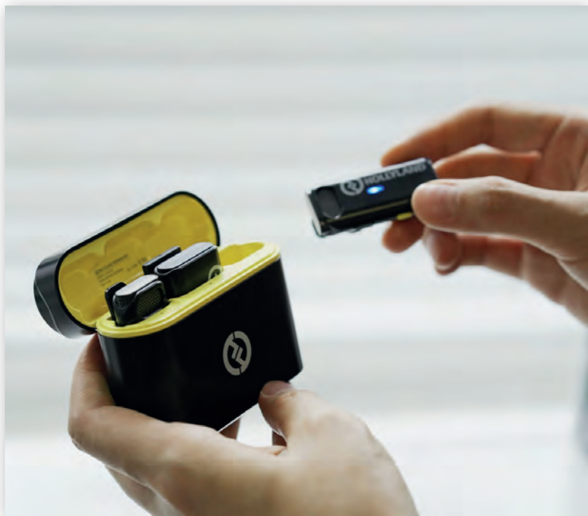
Футляр со встроенным аккумулятором служит для хранения, транспортировки и зарядки передатчиков и приемника
