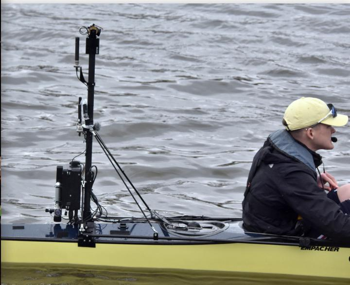
Съемочная система, установленная позади рулевого
