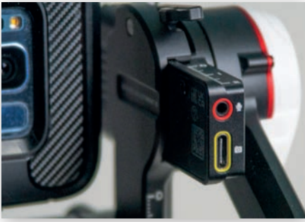
Порты подключения камеры и внешнего микрофона
