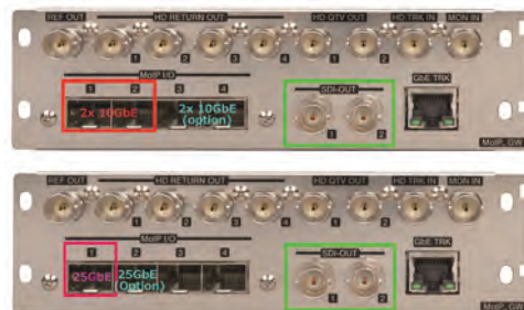
Модуль MoIP с двумя портами 10GbE (вверху) и одним портом 25GbE
