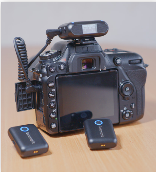
Микрофонная система, подключенная к камере
