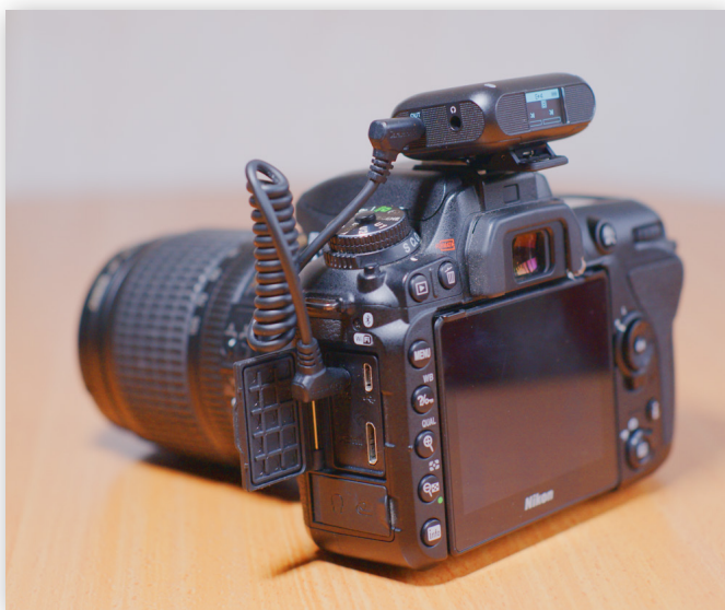
Подключение приемника к камере с помощью аудиокабеля
