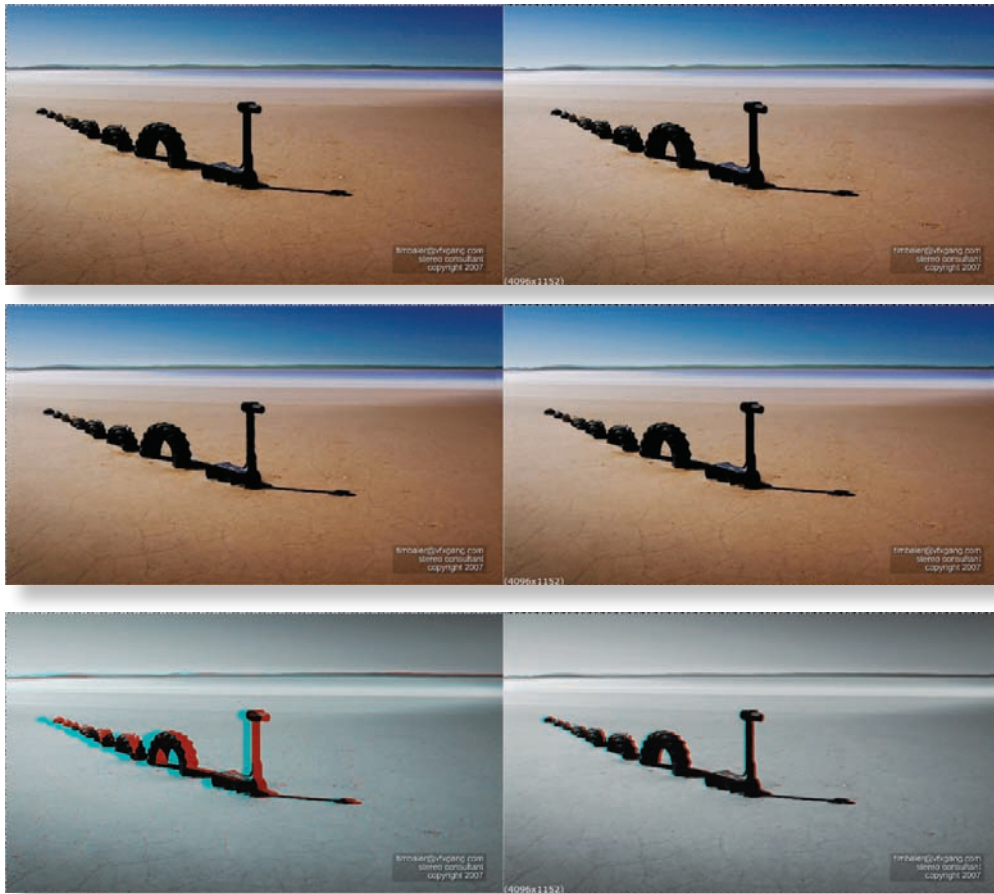
Рис. 5. Пример изменения межосевого расстояния с помощью Oscula. Верхний ряд – исходные левый и правый ракурсы. Средний ряд – левый и правый ракурсы после приближения одного к другому на 40% стереонесоответствия. Нижний ряд – анаглифический вид пары изображений до и после межосевого смещения.
