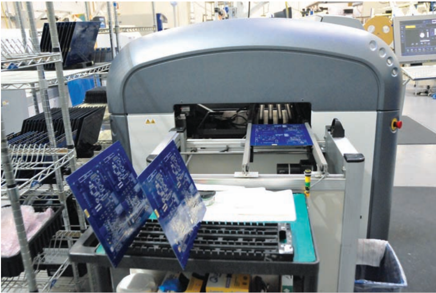
Станок, выполняющий автоматизированную установку компонентов на многослойные печатные платы
