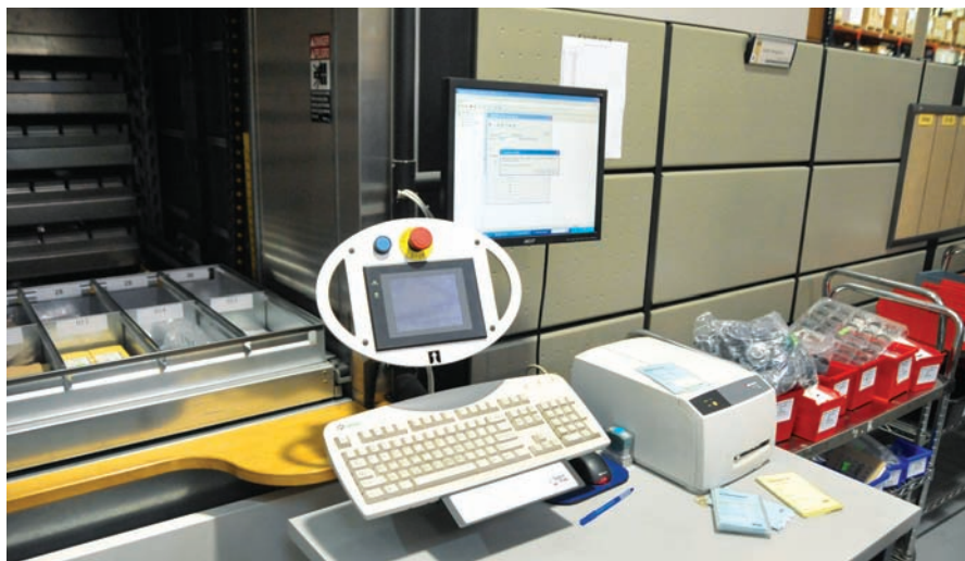
Автоматизированная система учета, поиска, подбора и выдачи компонентов Power Column 2 существенно повысила эффективность производства
