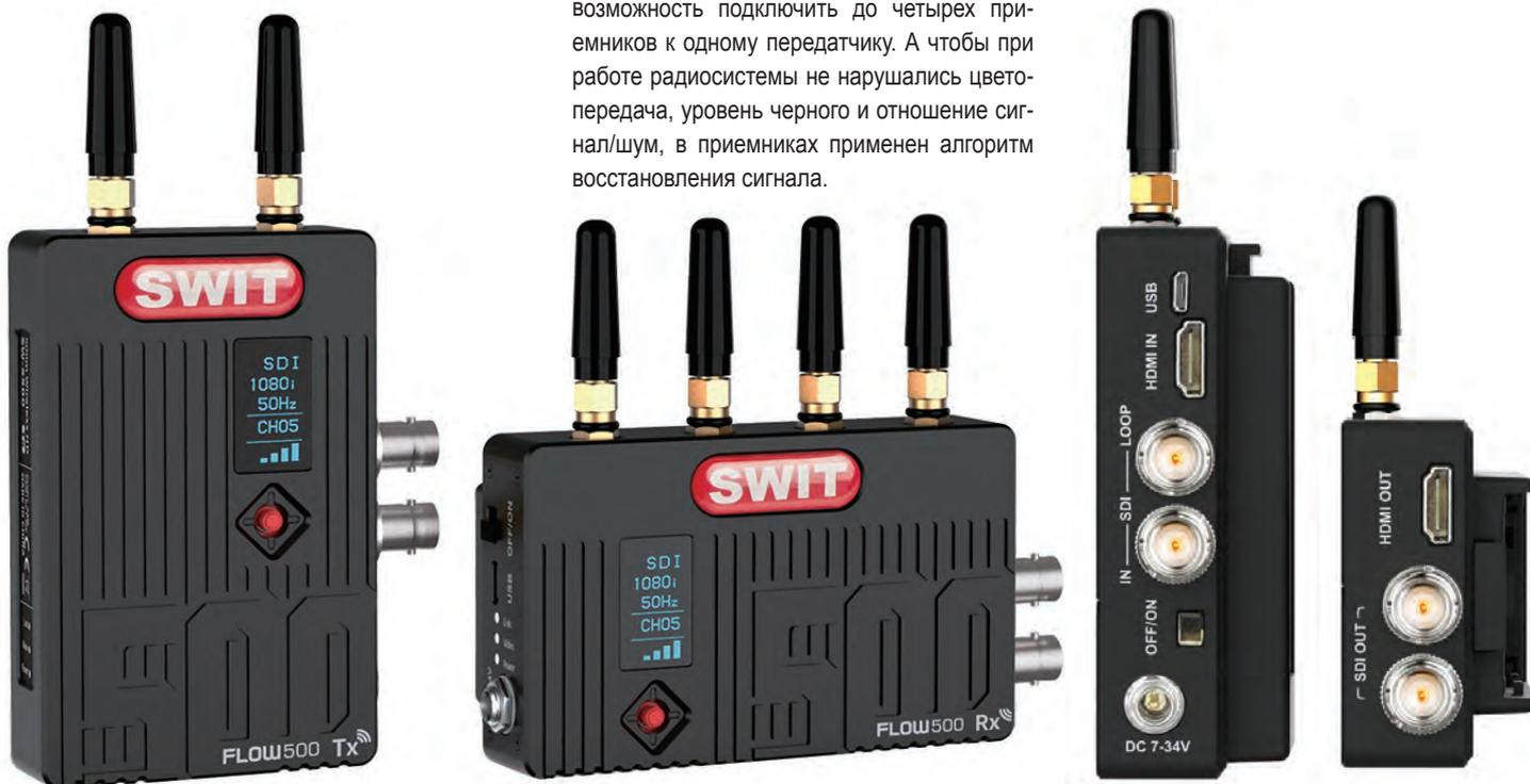
SWIT FLOW500: передатчик (слева) и приемник
