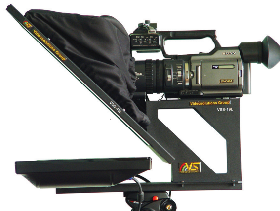
Взаимное расположение телеведущего, камеры и телесуфлера
