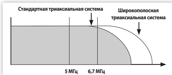
Сравнение АЧХ широкополосной и обычной триаксиальных систем
