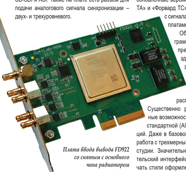
Плата ввода/вывода FD922 со снятым с основного чипа радиатором
