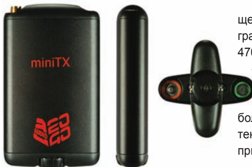
Передатчик mini-TX: вид спереди, сбоку и снизу (с открытой крышкой батарейного отсека)
