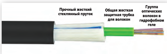
Рис. 2. Конструкция кабеля со свободным буфером
