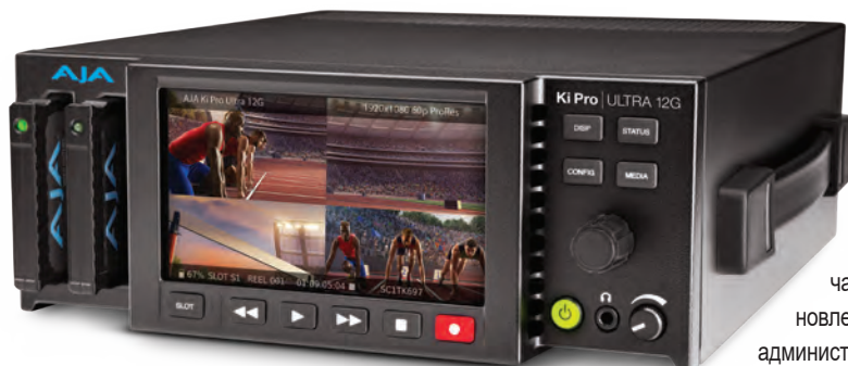
Ki Pro Ultra 12G в режиме записи четырех HD-каналов одновременно
